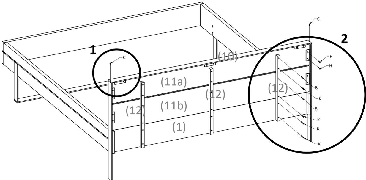
[2.1] Montage der Querstrebe (10) an das montierte Kopfteil mit Schraube (C).
